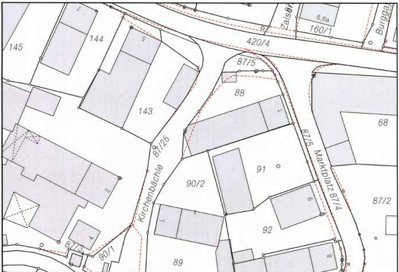
◆ Ausschnitt aus der digitalen Flurkarte mit altem (rot gekennzeichnet) und neuem Grenzverlauf.
